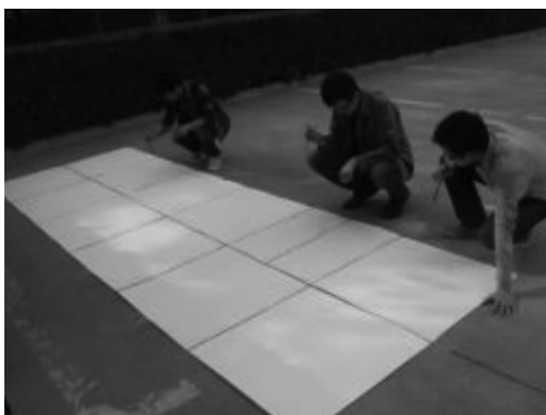
图2 绘制道面损伤
