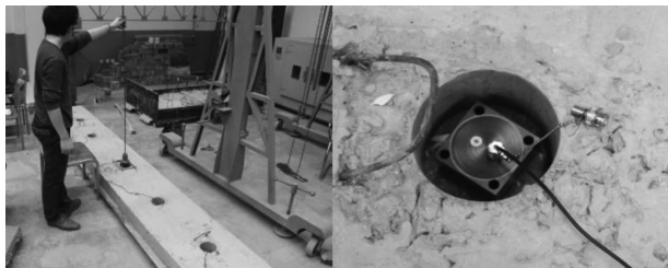
图2 预留孔道面板振动测试试验示意图
