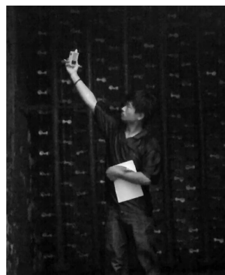
图2 测试喷水室的热湿交换效率
