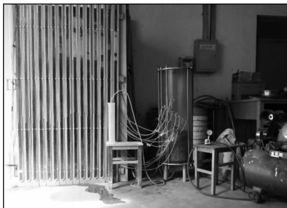
图2 泥浆渗透时土层中孔隙水压力监测试验装置
