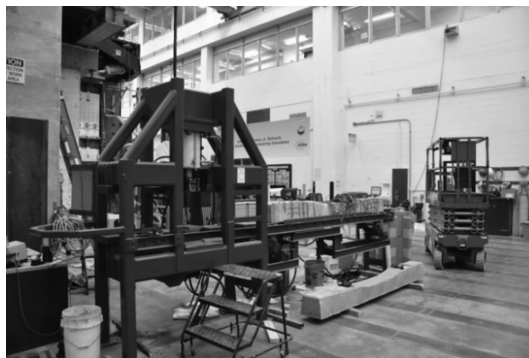
图2 UIUC 铁道中心枕轨试验系统
