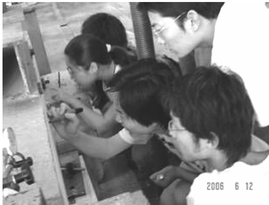
图1 采用读数显微镜观测混凝土的开裂情况
