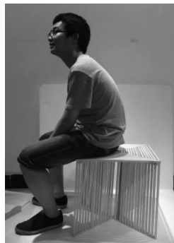
图7 椅子接受承重实验
