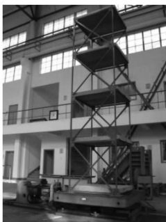
图 2 钢框架减震实验
