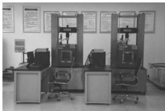
图5 沥青混合料小梁弯曲实验
