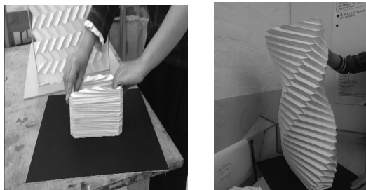
图 14 核心筒状折纸模型折叠和展开状态
