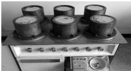
图2 现有抗渗仪及抗渗试验照片
