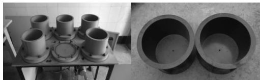
图3 现有抗渗仪混凝土试件试模
