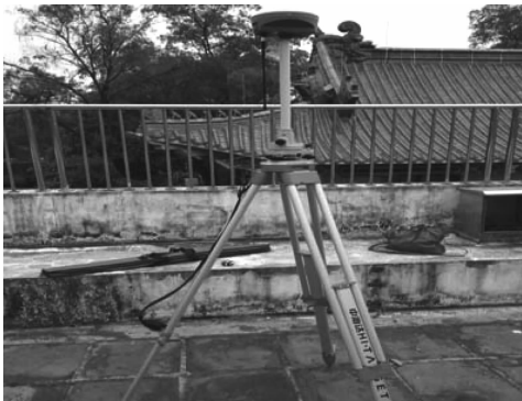
图3 探索 GNSS RTK 系统用于学生实践教学
