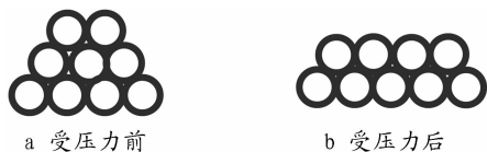
图1 受压力前后的土体(假设土颗粒如乒乓球一样大)
