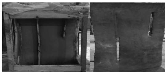
(a) 曲面缩尺模型浇筑 (b) 曲面缩尺模型展示
