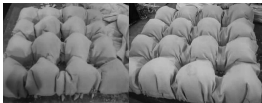
(a) 节点加强前的石膏模型 (b) 节点加强后的石膏模型
