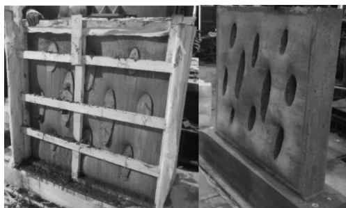
(a) 全尺模型浇筑 (b) 最终全尺模型
