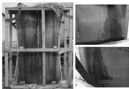
(a) 初步模型浇筑 (b) 初步模型缺陷
