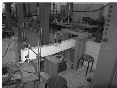
图5 简谐激振实验
