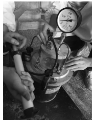
图6 砼含气量测试
