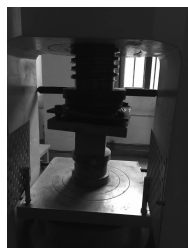
图3 砼抗压强度测试
