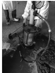
图5 砼泌水率测试
