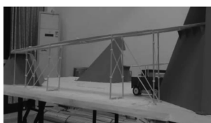
(b) B 桥段索-梁组合实物图
