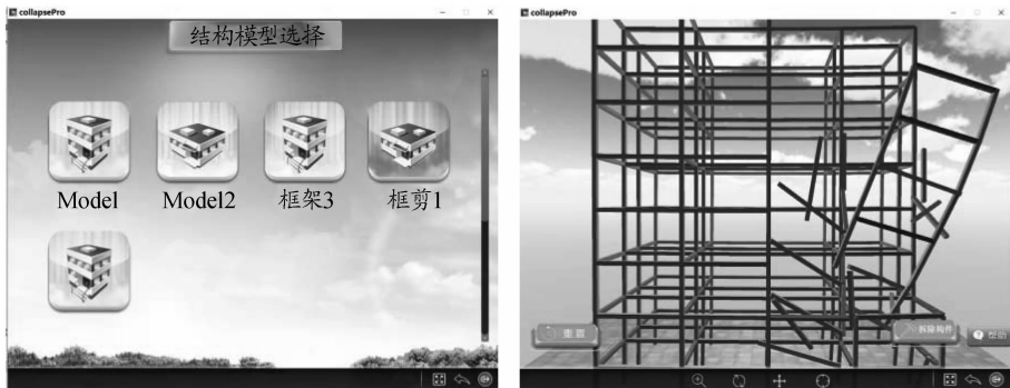
图 6 结构连续倒塌虚拟仿真实验
