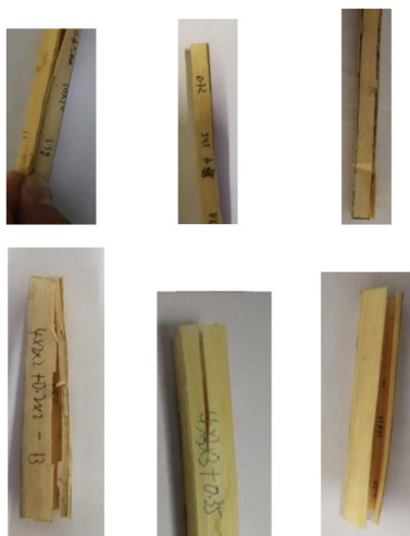
图 4 棱角开裂破坏形态
