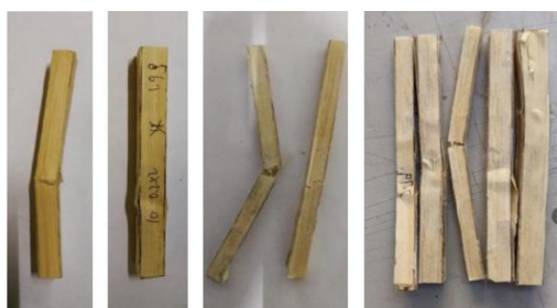
图 3 跨中破坏形态
