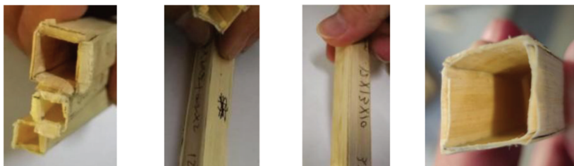
图 2 端部破坏形态
