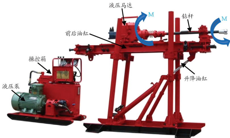
图5 矿井探放水钻机
