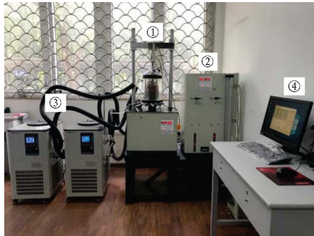
图 2 温控桩-土接触面三轴试验系统 [5]
