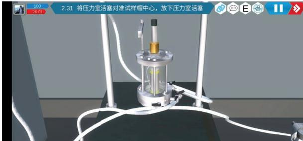
图 5 安装轴向测力计界面
