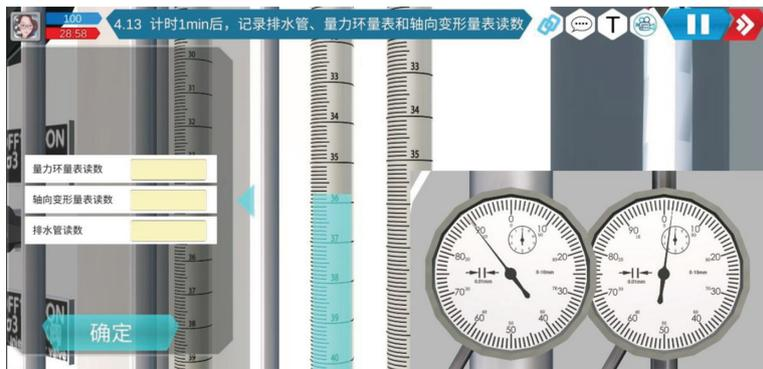
图 7 量力环读数、轴向变形读数、排水管读数界面
