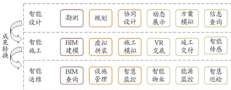
图 4 嵌入数字孪生技术的建设项目智能管理数字化平台框架
