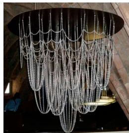
图 24 悬链逆吊法装置
