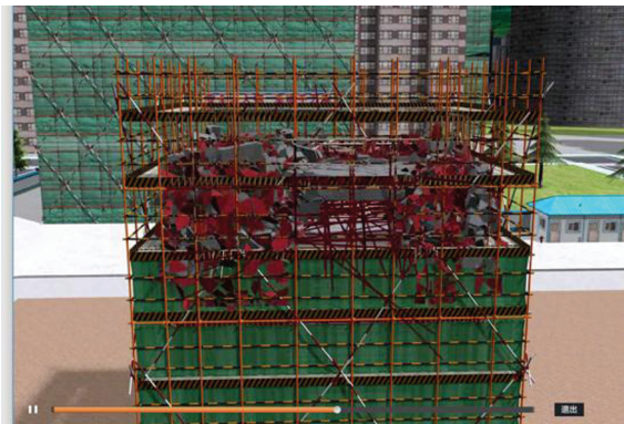
图5 构件搭设不合理,支撑架垮塌警示
