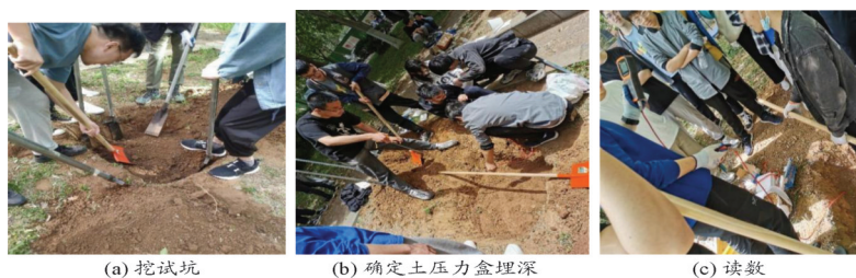
图4 超载下土压力测试现场开展情况
