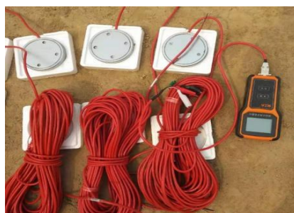
图2 JTM-V2000型振弦式土压力计及JTM-V10A型频率读数仪
