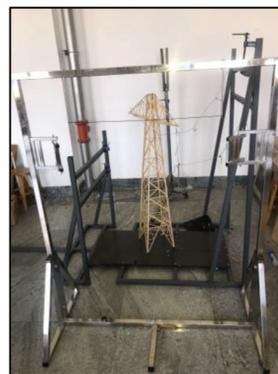
图4 输电塔多向加载装置
