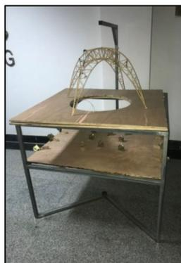
图3 大跨屋盖竖向加载装置
