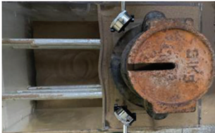
(b) 方案四挡土结构变形
