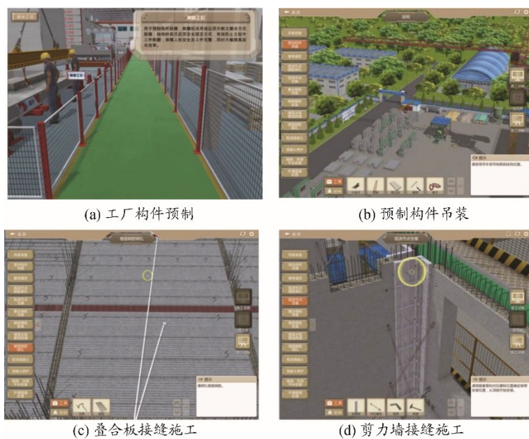
图1 装配式建筑结构设计施工虚拟仿真实验教学平台部分施工流程展示
