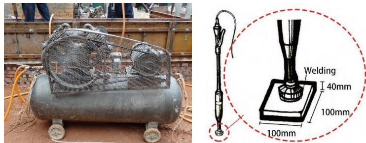
图9 电动空气压缩机与气动夯锤示意图
