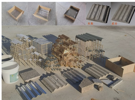
图3 以波纹板为模具的混凝土浇筑实验
