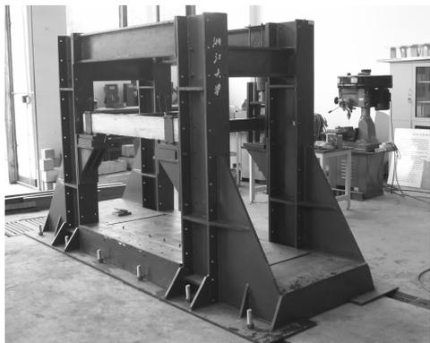
图 4 钢筋混凝土构件受扭试验照片
