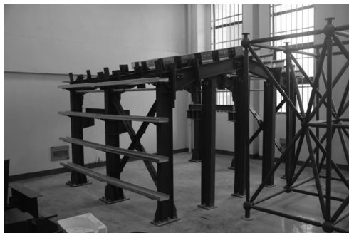
图5 门式刚架及网架结构实训平台
