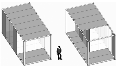
图3 维护结构可根据模数变化调整
