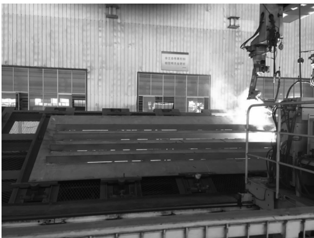
图2 钢板自动焊接技术
