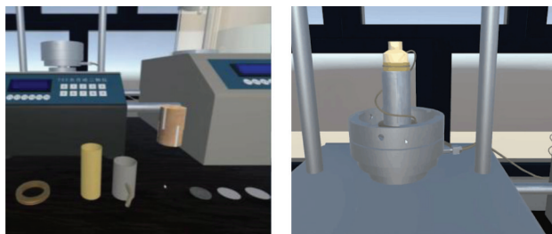
图 7 三轴剪切试验试样安装
