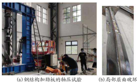
图1 本科生参与的破坏性试验
