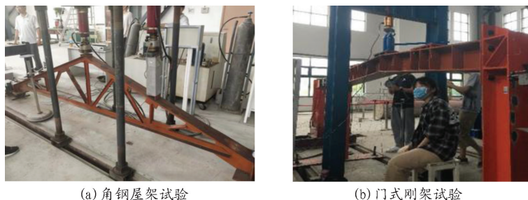
图2 本科生常见的两类整体钢结构非破坏性试验
