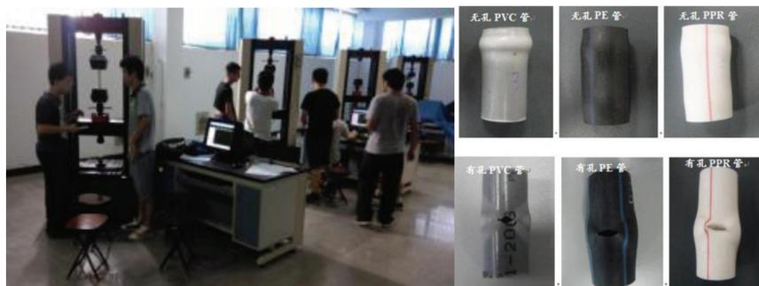
图3 瓦斯抽采护孔管的轴向拉伸、压缩和扭转试验<sup>[15]</sup>
