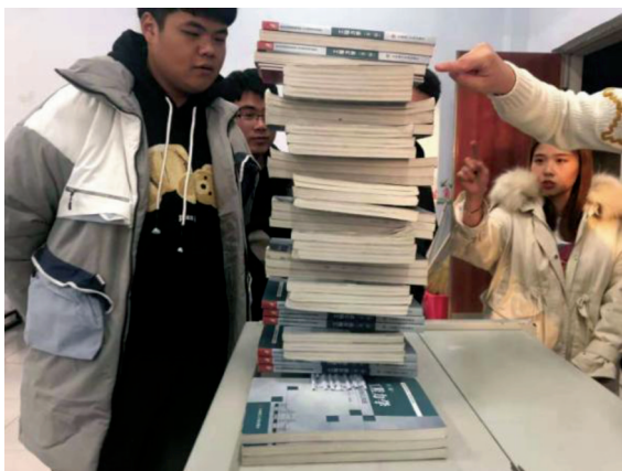
图2 纸质桥梁模型加载现场
