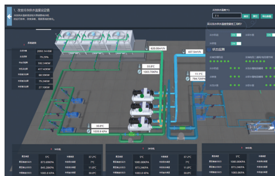
图4 冷水机组不同工况虚拟实验
