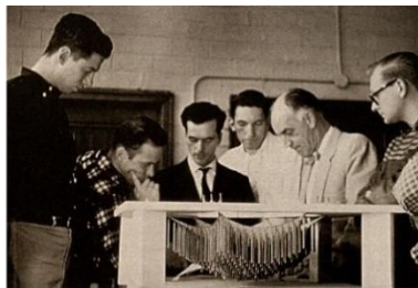
图4 奥托在轻型结构设计课中使用的逆吊模型 [4]
